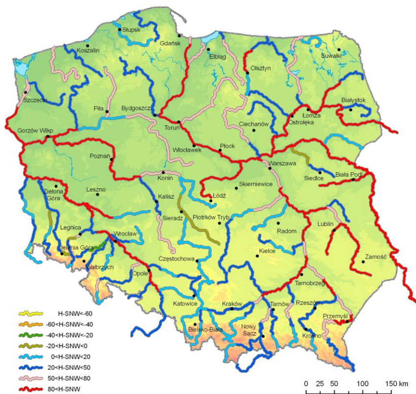
Rys. 3.2. Stan wody w rzekach (30 IV 2010) w stosunku do SNW
